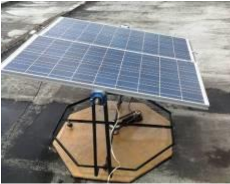
Fig.7. Generador energía solar tipo girasol instalado.
