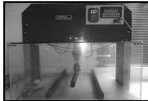
Fig. 8: Equipo para medir la resistencia a la flexión
