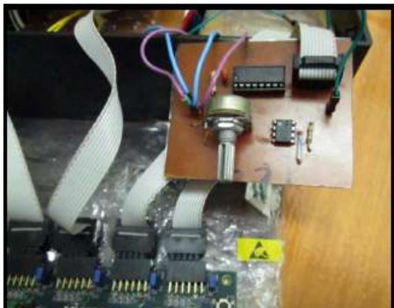
Fig. 7. Tarjeta de transmisión de datos con DAC0808.
