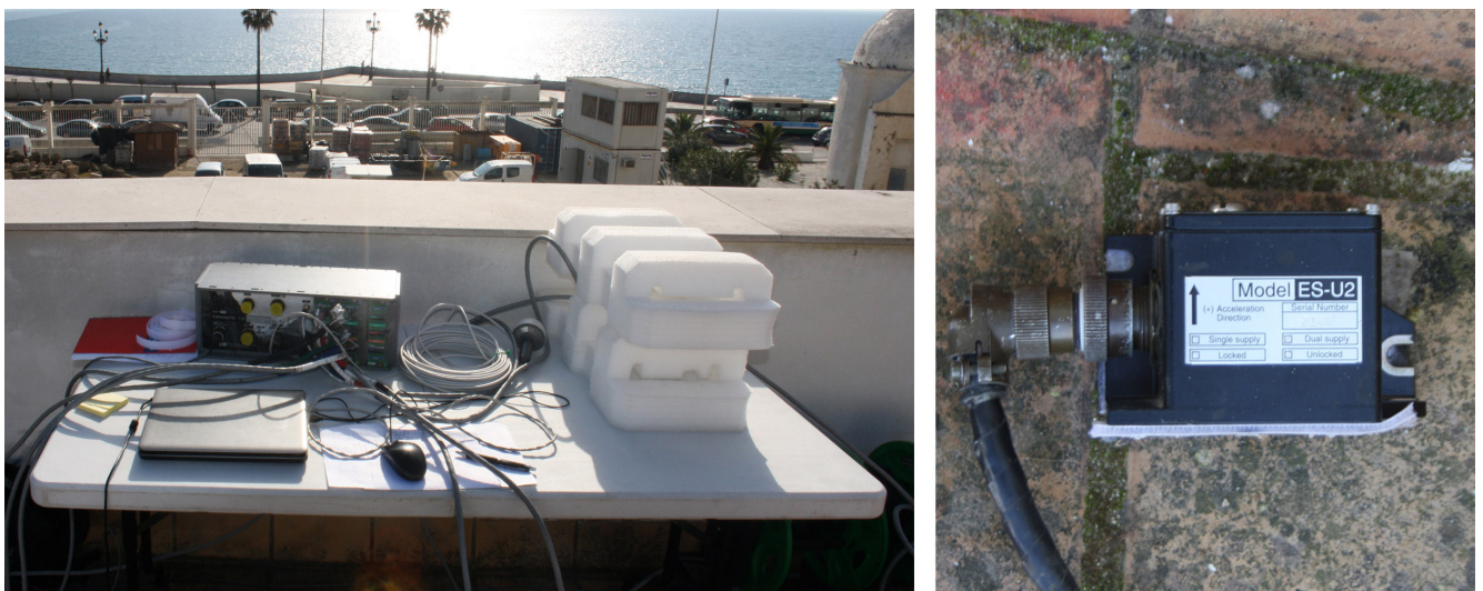
Figura 13. Central de Adquisición de datos, equipo informático y acelerómetro de fuerza balanceada.
