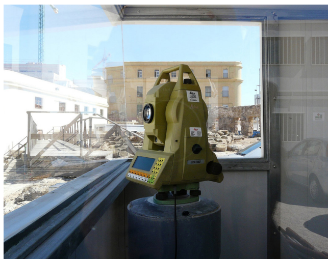
Figura 6. Estación fija de control topográfico.
