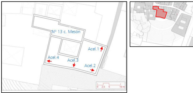
Figura 12. Situación, dirección y sentido de los acelerómetros de referencia.
