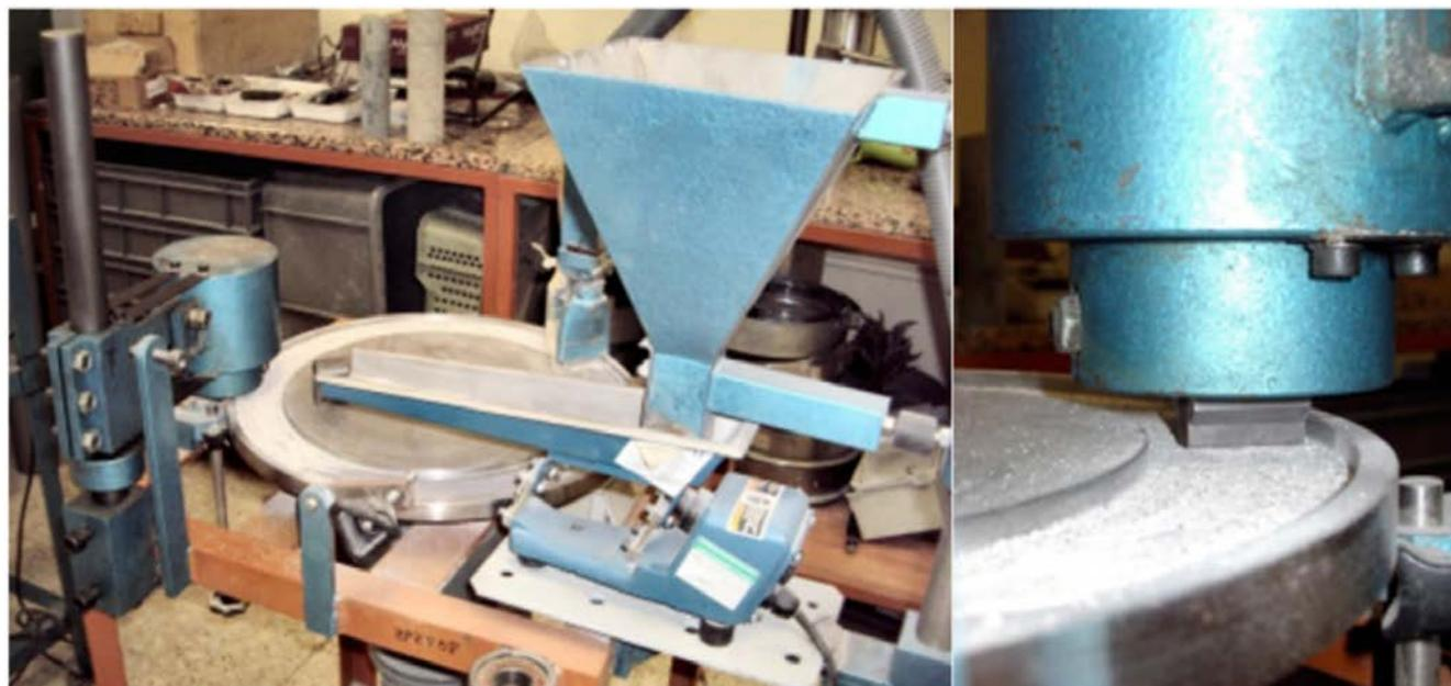
Figura 2. Máquina para ensayos AVS (Laboratorio de Mecánica de Rocas, ETSIME-UPM).
