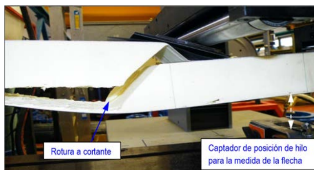
Figura 4. Rotura a cortante, sin colapso de la chapa del panel.
