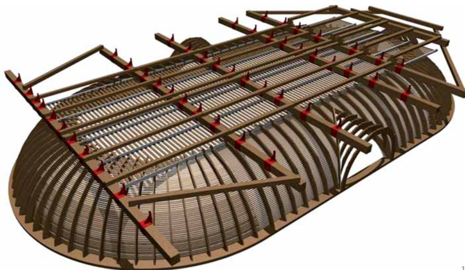
11. Planta del extradós de la bóveda con indicación de los elementos constructivos.
