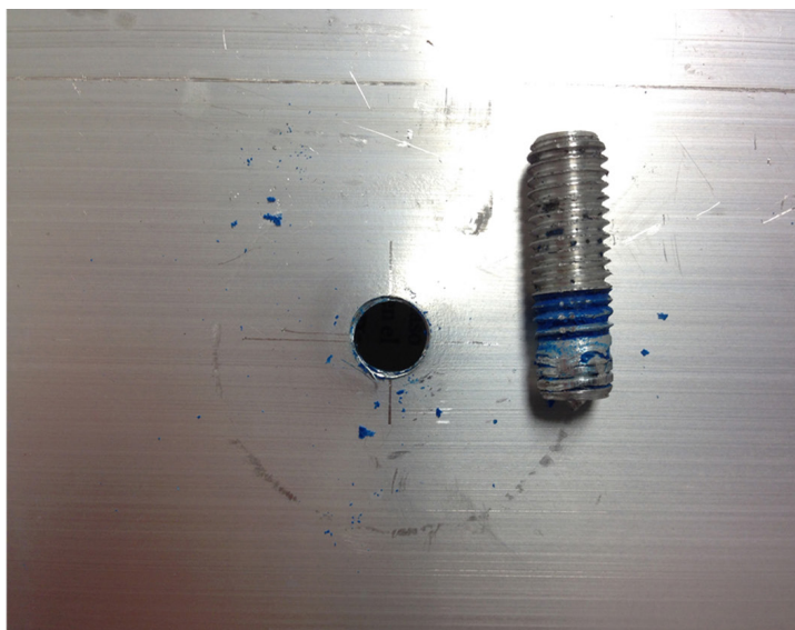
Figura 9. Detalle del estiramiento del tornillo y detalle del fallo en la rosca de la varilla (Archivo LITEM).
