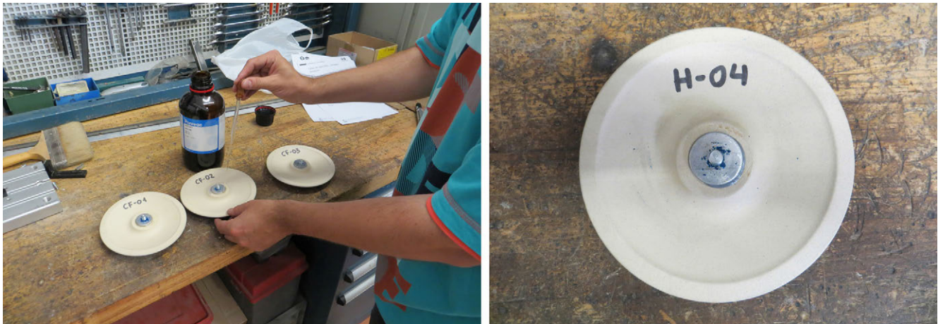
Figura 14. Aplicación de anilina en las muestras y detalle sin presencia de fisuras (Archivo LITEM).
