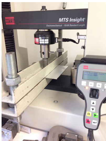
Figura 8. Método de ensayo para el pull-out con los dos procedimientos utilizados (Archivo LITEM).
