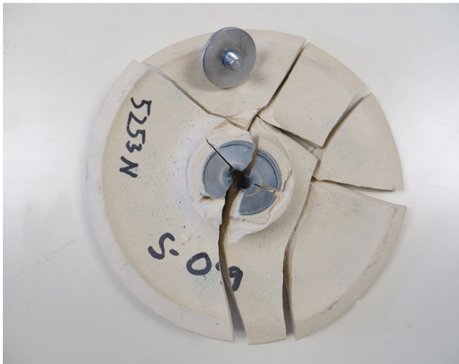
Figura 11. Modo de rotura de las muestras (Archivo LITEM).
