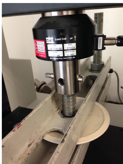
Figura 10. Método de ensayo pull-out entre el disco cerámico y su varilla roscada (Archivo LITEM).
