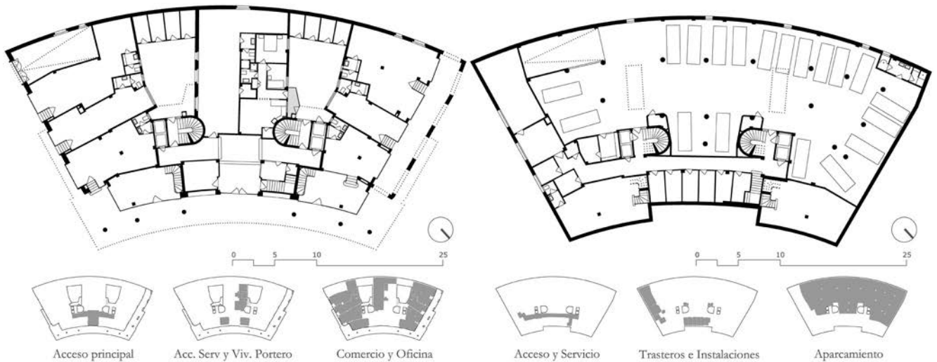
Figura 8. Planta Baja y Sótano y esquemas de uso. Inmueble nº 7-8. Escala 1:600. Dibujo del autor.
