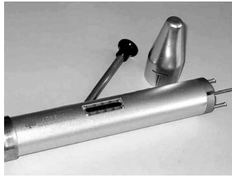
Figura 1. Equipo de penetración de varilla (Pilodyn).
