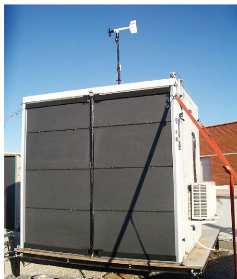
Figura 3. Recinto instrumentado para exposición ambiental de cerramientos (izquierda). Resultados comparativos de temperatura máxima en piezas (derecha).
