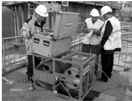
Figura 7. Medición del perfil real de la excavación con Koden.
