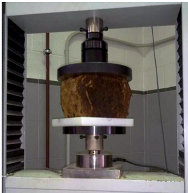
Figura 2. Probeta de la familia 1 después del ensayo.
