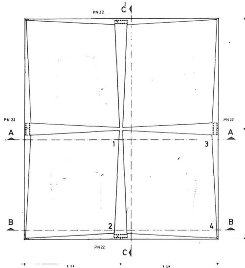
MEMBRANA: Srima de espesor ARMADO 148cc/da/10cm en ambas direcciones
