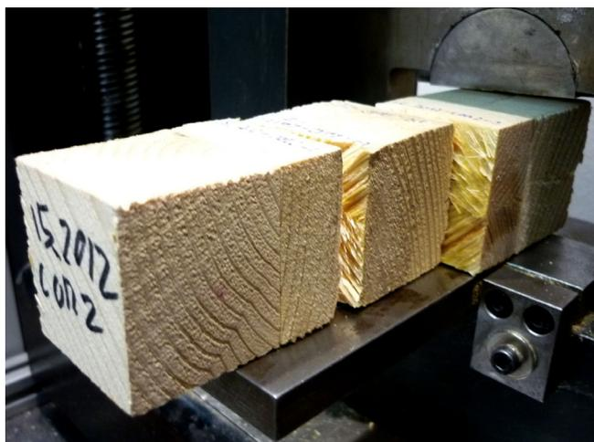
Figura 7. Ensayo de esfuerzo cortante de probetas contralaminadas.
