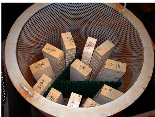
**Figura 5.** Ensayo de delaminación. Probetas en autoclave.
