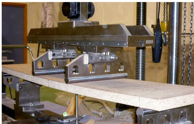
Figura 2. Ensayo de flexión en tablero de partículas.
