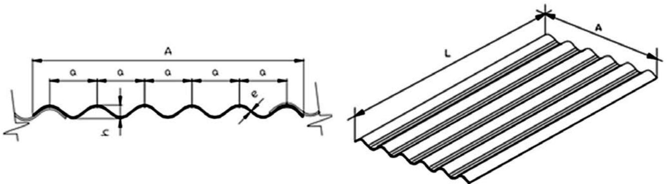
Figura 2. Modelo geométrico de la plancha acanalada de fibrocemento (7).
