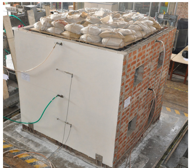
Figura 6. Ensayo de prototipos 1 y 2 con el SAI combinado con adobe o ladrillo hueco.
