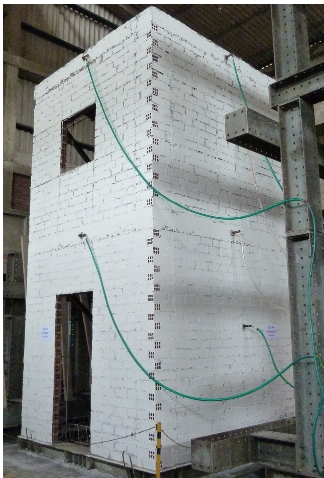
Figura 7. Prototipo 3 terminado, construido con SAI y ladrillo hueco, 1/4 de vivienda a escala real y estructura metálica en los ejes de simetría para simular la rigidez de una vivienda completa.
