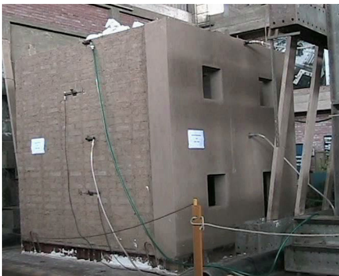
Figura 6. Ensayo de prototipos 1 y 2 con el SAI combinado con adobe o ladrillo hueco.
