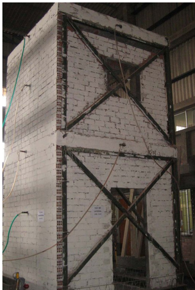
Figura 7. Prototipo 3 terminado, construido con SAI y ladrillo hueco, 1/4 de vivienda a escala real y estructura metálica en los ejes de simetría para simular la rigidez de una vivienda completa.
