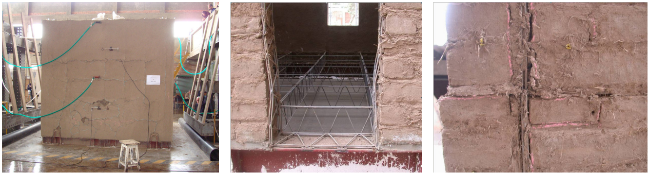
Figura 8. Prototipo 1, de adobe, después del ensayo. Vista general, puerta y una esquina.
