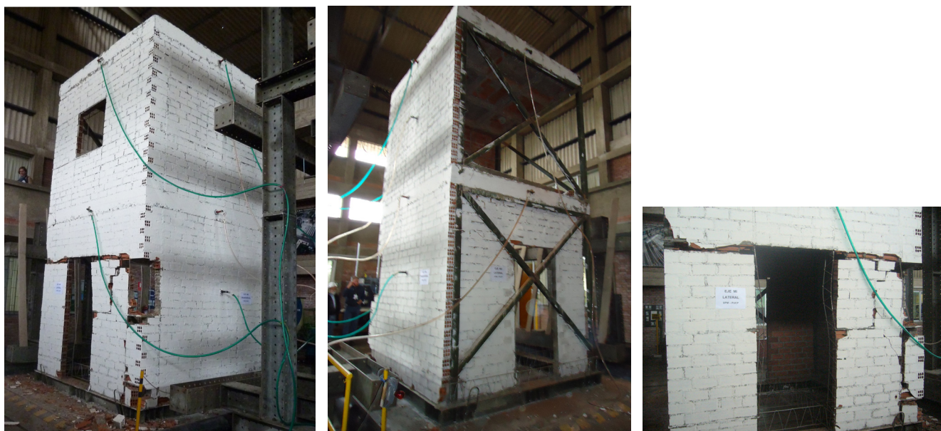
Figura 10. Prototipo 3, de ladrillo escala real, después del ensayo.
