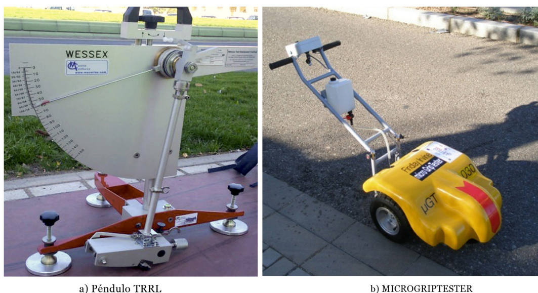
a) Péndulo TRRL b) MICROGRIPTESTER Figura 1. Equipos de medida de la resistencia al deslizamiento/derrape en vías ciclistas
