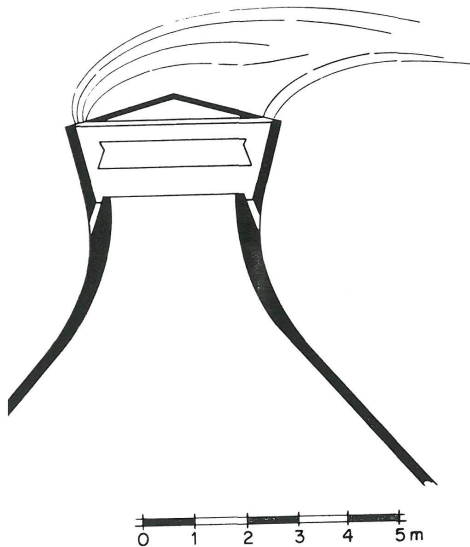
Esquema de circulación del humo en el modelo de ensayo.
