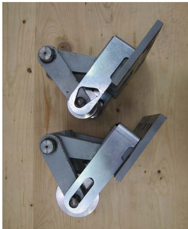
Figura 1. Imagen del mecanismo de autotesado (SsS ® ) en diferentes configuraciones geométricas.
