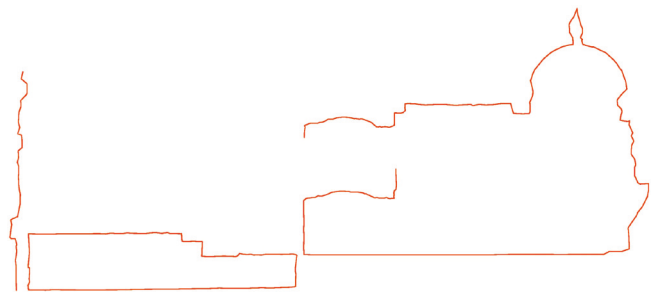
Figura 10. Trazado vectorial de la sección a partir de la nube de puntos. (Elaboración propia).
