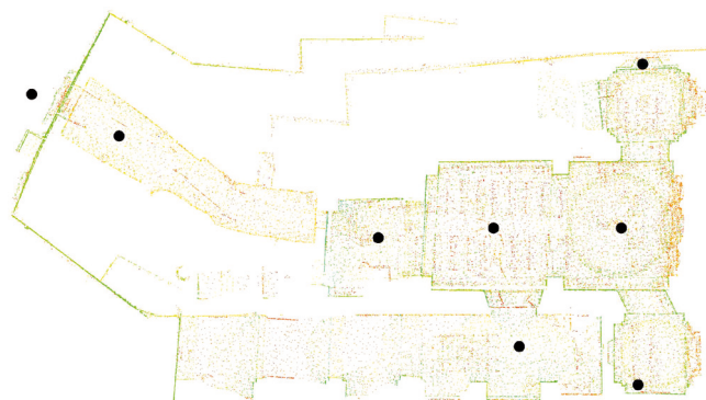
Figura 5. Planta de la capilla, cuya parte derecha se corresponde con la misma zona objeto de estudio de la Figura 3. Se señalan con puntos los 8 lugares de estacionamiento para las tomas con el láser escáner. (Ingeniería Geomática y Patrimonio Urbano, IGPU. (2011). Toma de datos mediante láser escáner del Santuario de la Montaña. Universidad de Extremadura. Cáceres).
