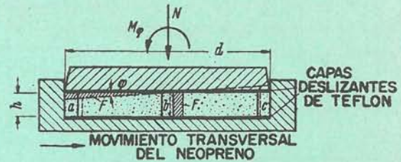
Fig. 8.—Apoyo de caja fija rellena de neopreno, placa delgada, dos capas de material deslizante. Deformación tangencial del neopreno, nula o insignificante.
