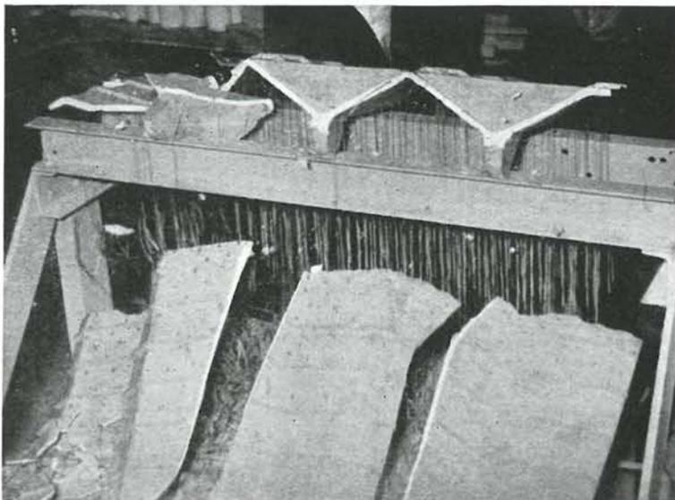
El sistema de cargas lo formaban 1.130 bandas de goma, previamente tiradas, unidas al modelo, por un lado, según una retícula distribuída de tal forma que representase la variación de peso real de la lámina, y por el otro, a una losa de hormigón desplazable en dirección vertical por medio de gatos de husillo. La medida del alargamiento de las bandas de goma indicaba la carga transmitida al modelo.
