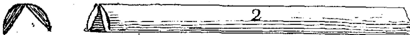
Figura 3. Formaleta (tomado de Juan de Villanueva, Arte de albañilería, 1827, lám. IX, fig. 2).
