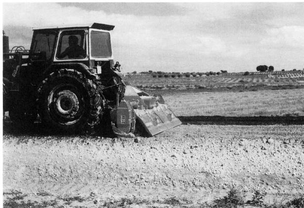
Fig. 9.- Detalle del segundo pase de fresadora. Detalle de mezclado.
