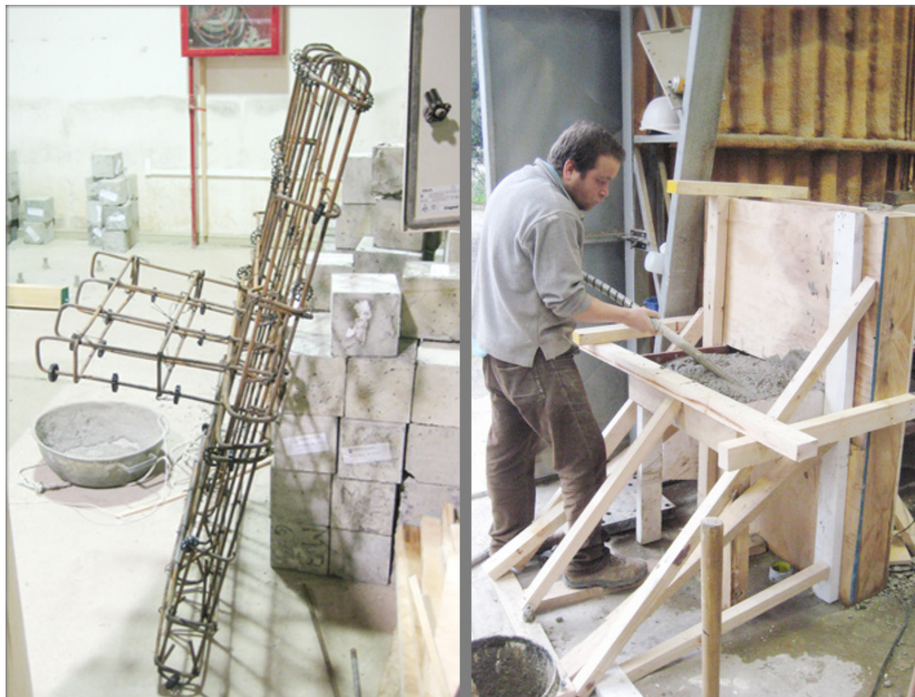
Figura 3. Proceso de elaboración de probeta de hormigón armado.
