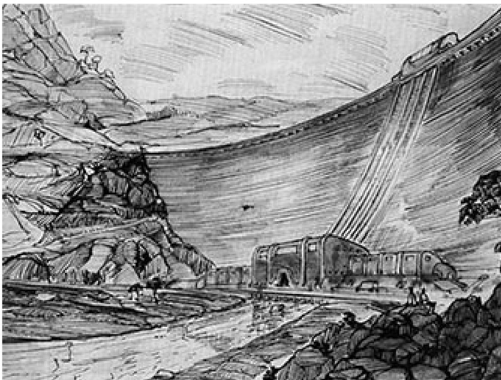
Figura 16. Único boceto del que se tiene constancia realizado por Fernández-Shaw. Apréciase que el diseño propuesto dista mucho de la solución final construida, aunque ya se ensaya con las formas futuristas y dinámicas de la sala de máquinas.
