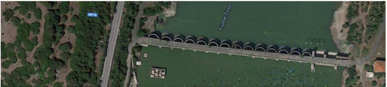
Figuras 8, 9 y 10. De izquierda a derecha y de arriba abajo. Detalle del encofrado de las bóvedas de la presa italiana de Santa Clara de Ula. Vista general de la presa con la sala de máquinas en el vano central. Imagen aérea en la que puede apreciarse la curvatura de las bóvedas (Fuente: Google Earth).
