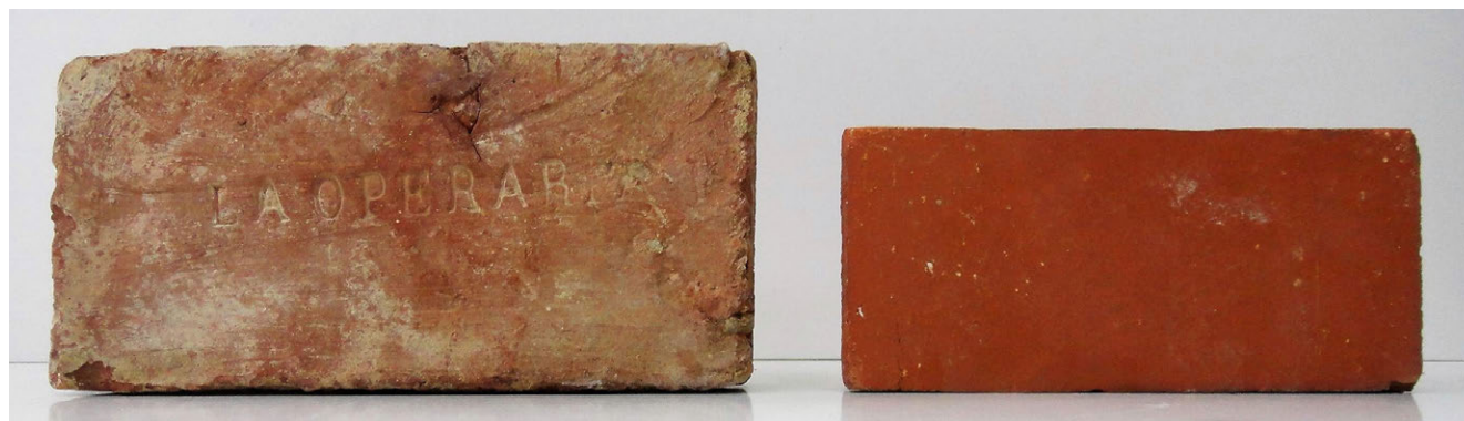
Figura 2. A la izquierda fotografía de un ladrillo de tejar y a la derecha fotografía de un ladrillo macizo moderno, empleados para realizar los ensayos.
