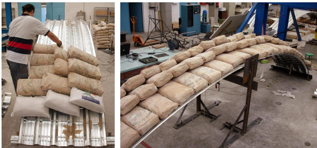
Figura 4. Ensayos de carga uniforme.
