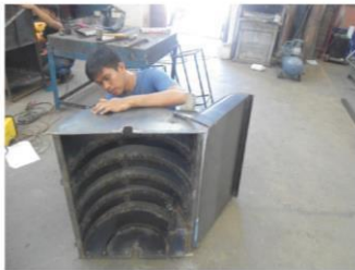
Gambar 7. Komponen Bagian Atas Thereser Multiguna
