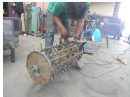
Gambar 6. Roda Perontok Pada Mesin Thereser Multiguna
