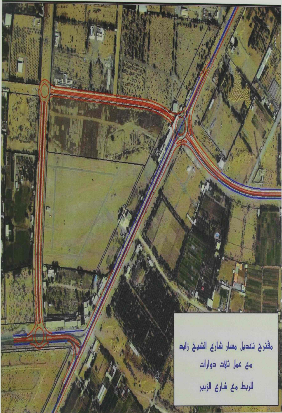
شكل ( 45 ) مقترح مقترح رقم (3) لدائرة البلدية والتخطيط في عجمان لتطوير وحل مشكلة الربط مع طريق الزبير
