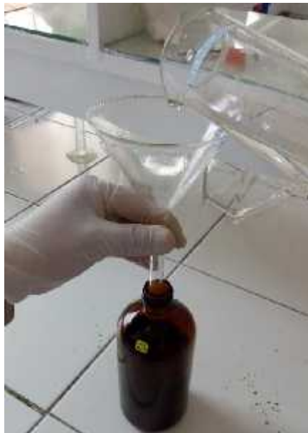
Figura 4. Frasco ambar con 19.34 g de inflorescencia seca y pulverizada. Se está vertiendo etanol de 96°.
