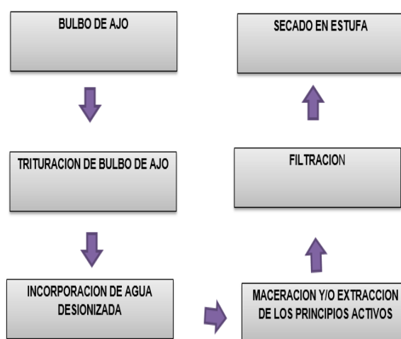
Figura N° 8: Flujograma de Extracción del Ajo ( Allium sativum L. )
