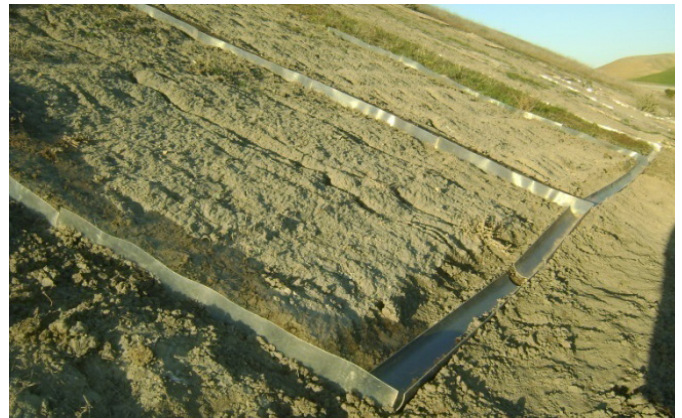
Figure 9: Collecteurs installés en bas des parcelles et séparations installées entre les différentes parcelles
