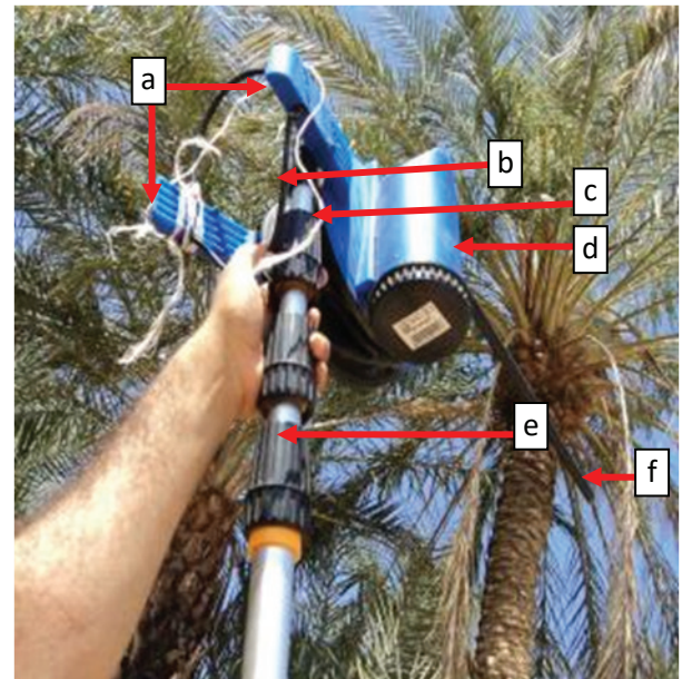
Figure 3: Pollinisateur, a) bras de la poudreuse; b) baguettes de rappel; c) fil de tirage ; d) poudreuse; e) perche télescopique; f) jeteur de la poudre
