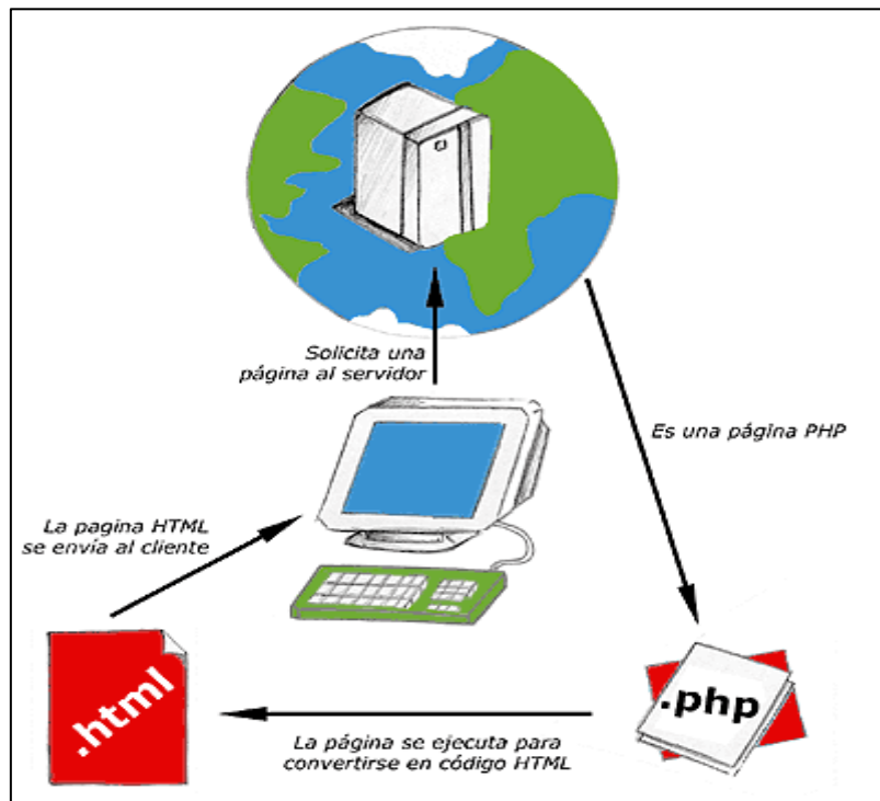
Figura 3.6: Esquema de funcionamiento de las páginas PHP – Fuente: Internet
