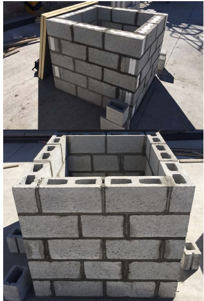
Figura 3a y 3b. Módulos de Isoblock y Block de concreto convencional. Fuente. Fotografías tomadas por el autor.
