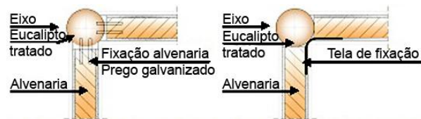
Ligação entre estrutura e alvenaria com prego galvanizado
