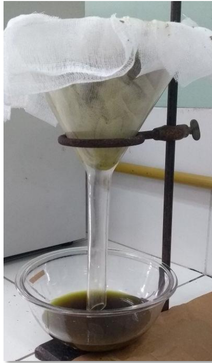
Figura N°43: Filtración de los macerados de hojas y brácteas de Cynara cardunculus L. (alcahofa)
