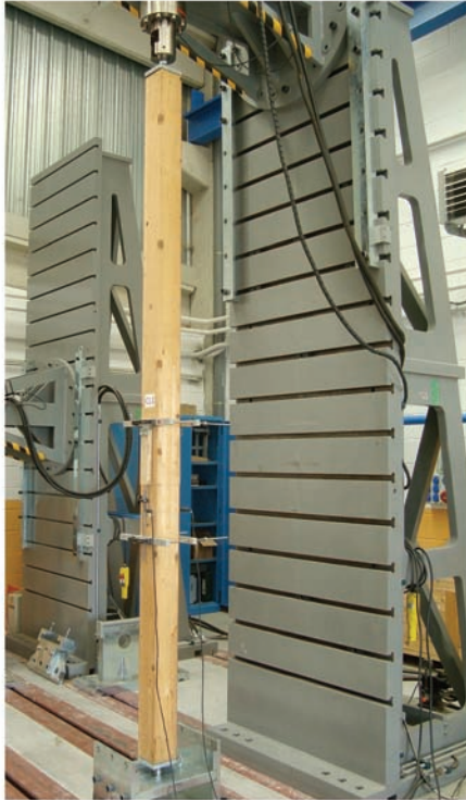
Figura 10. Dispositivo para el ensayo de compresión.
