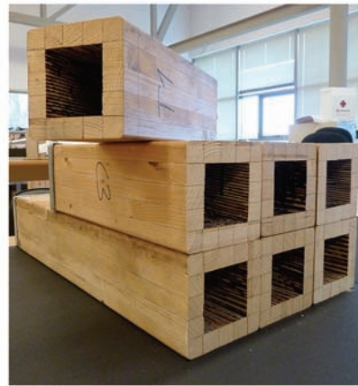
Figura 5. Barras de sección hueca.
