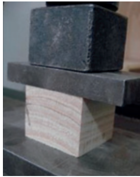
Figura 2. Probeta de pino radiata sometida a compresión perpendicular en máquina de ensayo universal.
