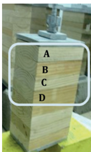
Figura 5. Probeta de tablero tensado de pino radiata mostrando la identificación y la posición de los tablones que la constituyen.
