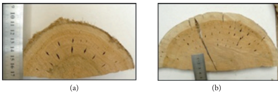
Figura 11. Imagen de grietas en anillos de crecimiento de E. nitens de 12 años en la altura de 3 metros (a) Sitio Mulchén (b) Sitio Yungay. Escala en cm.
