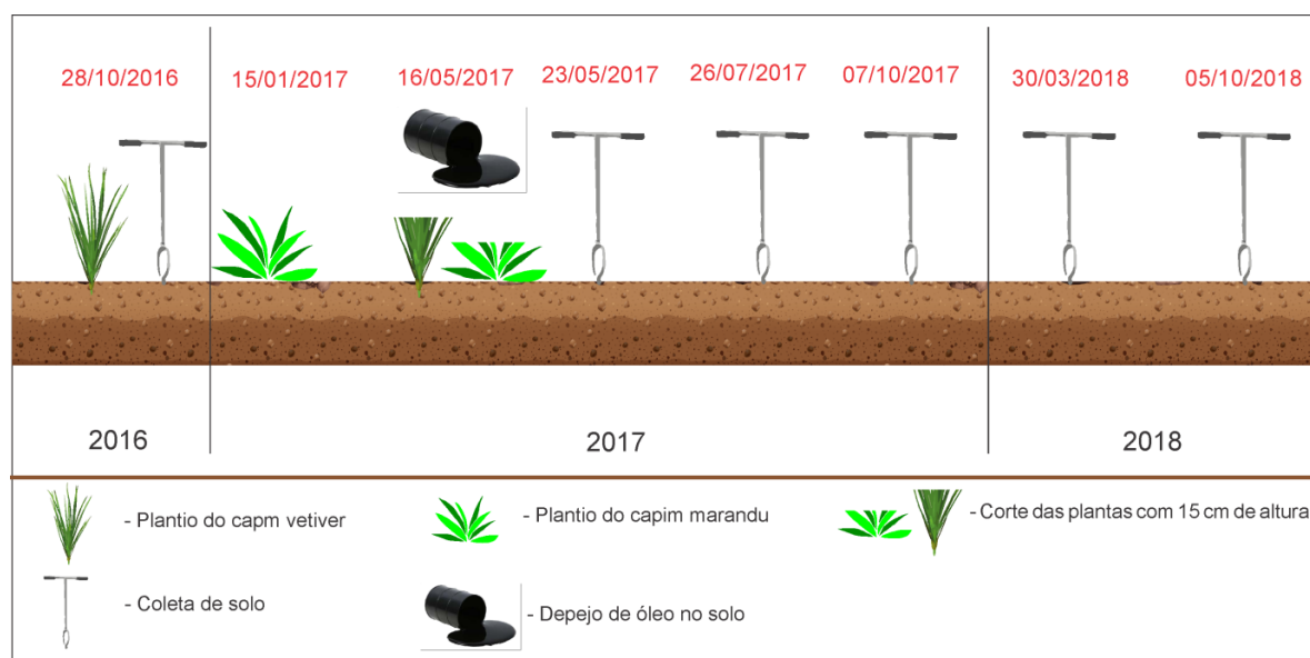
Figura 3 – Diagrama esquemático da variação temporal das diferentes etapas da condução experimental: plantio das espécies vegetais, disposição de óleo lubrificante usado no solo, corte das espécies vegetais e coleta do solo
