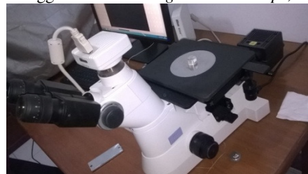
Gambar 7. Proses Pengujian Struktur Mikro
