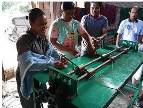
Gambar 6. Pembelahan pandan menggunakan mesin
