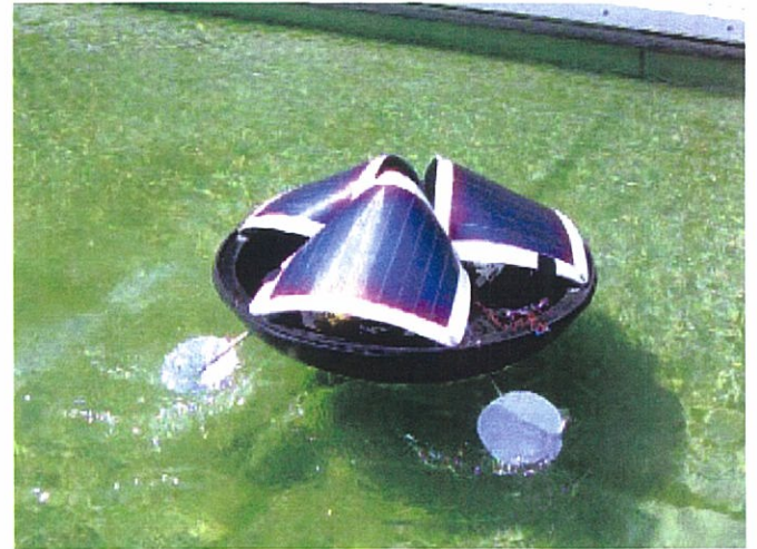
カバーを取り外し、二つの推進器によって運行する作業中のロボット
