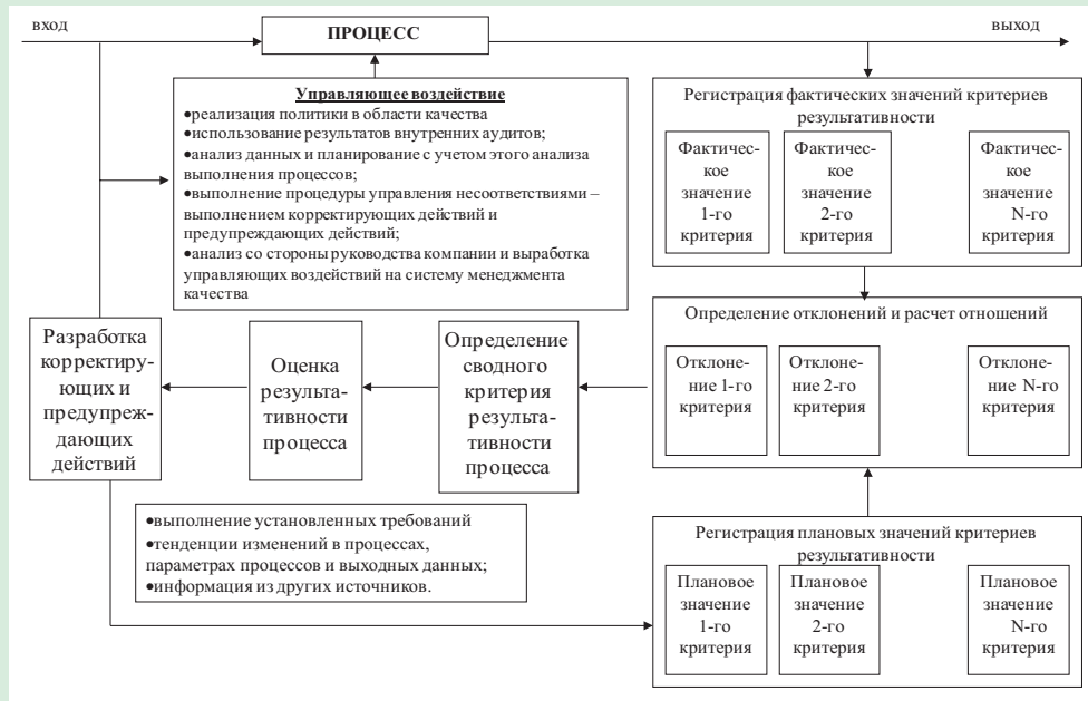
Рис. 2. Схема управления процессами на основе критериев результативности в рамках системы менеджмента качества
