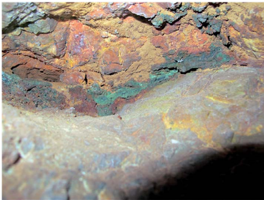
Lám. II.—Veta de malaquita junto a la cantera de la Cima y en el contacto entre las dolomías y las calizas magnesianas (pisos 3 y 4). En la base de esta veta se descubrió el pico MI-07 (ver infra).
