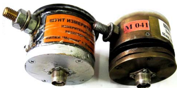
Рис. 4. Общий вид измерительного коаксиального шунта типа ШК-300 до (слева) и после (справа) протекания через него в сильноточной разрядной цепи высоковольтного ГИТМ-10/350 нормированного аperiodического импульса тока искусственной молнии временной формы 15/315 мкс с амплитудой I_{mL} \approx 184 кА ( q_L \approx 81,3 Кл; J_L \approx 7,88 \cdot 10^6 А 2 ·с)
