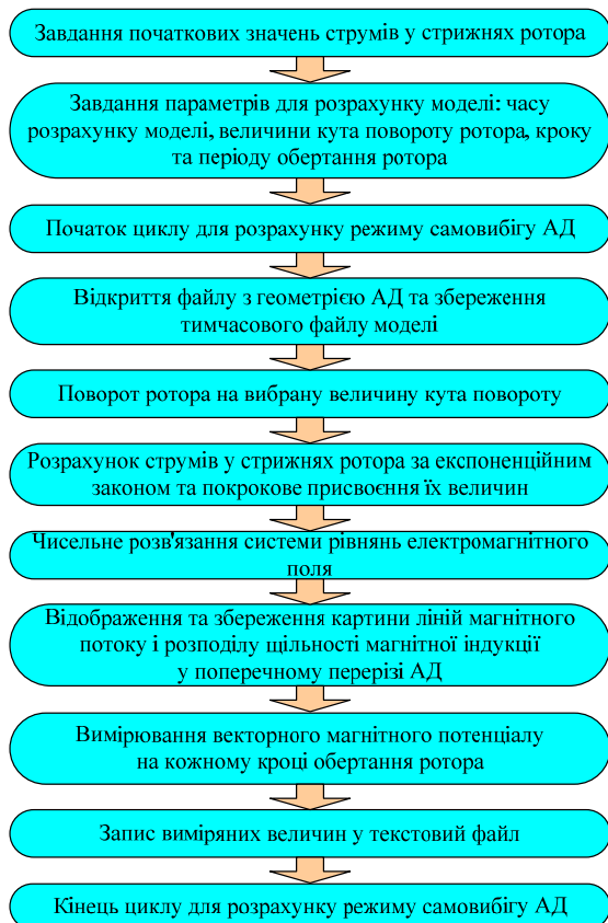
Рис. 6. Послідовність дій при розрахунку ЕМП у поперечному перерізі АД
